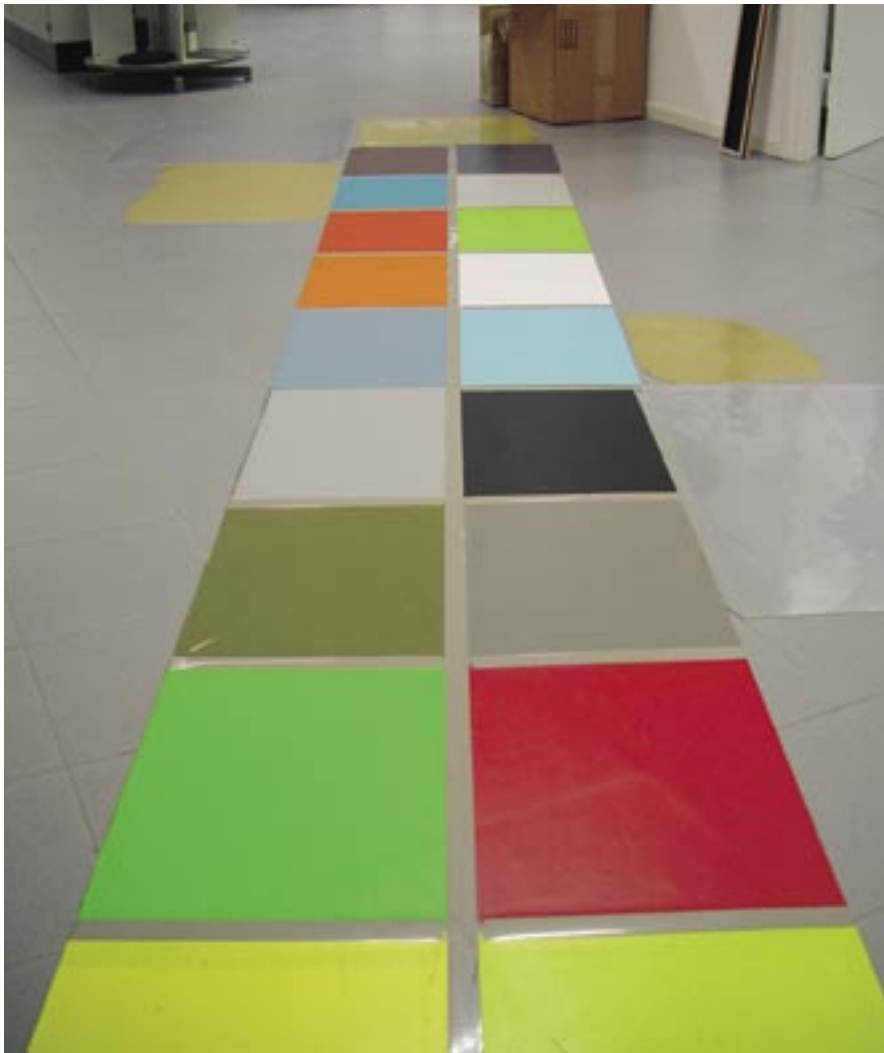
De teststukjes liggen vastgetaped op de vloer precies in de loopprijs van al het laboratoriumpersoneel.
